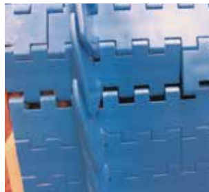
1 Mueva ambos extremos de la banda hasta que se entrelacen correctamente
